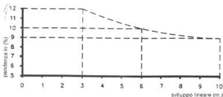
Per pendenze del 5% prevedere ripiano di sosta ogni 15 metri; per pendenze superiori, la lunghezza va proporzionalmente ridotta fino a 10 metri per pendenze dell'8% (DM 236/89).
