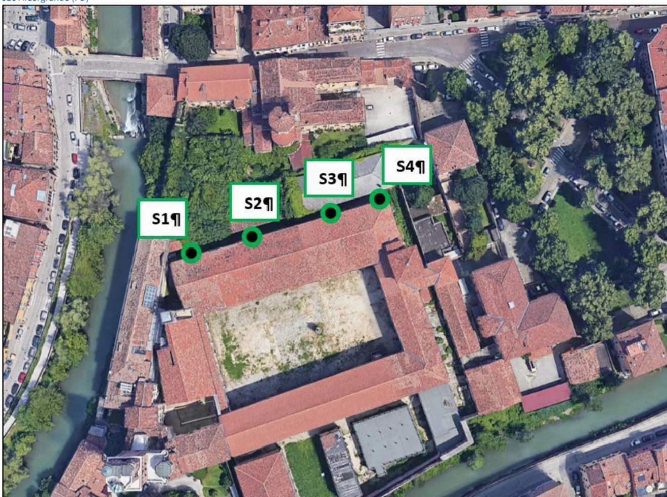
21_ sondaggi per l'analisi dei terreni (ottobre 2022)
