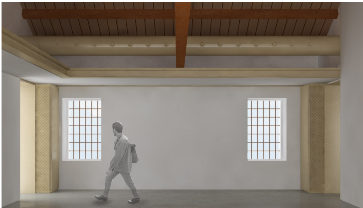
67_sala tipo a doppia altezza, piano secondo: a ridosso dei varchi i "totem" tipo T3 con griglie per i plenum di ripresa aria; in alto, nel sottotetto, i canali di mandata a vista con ugelli diffusori
