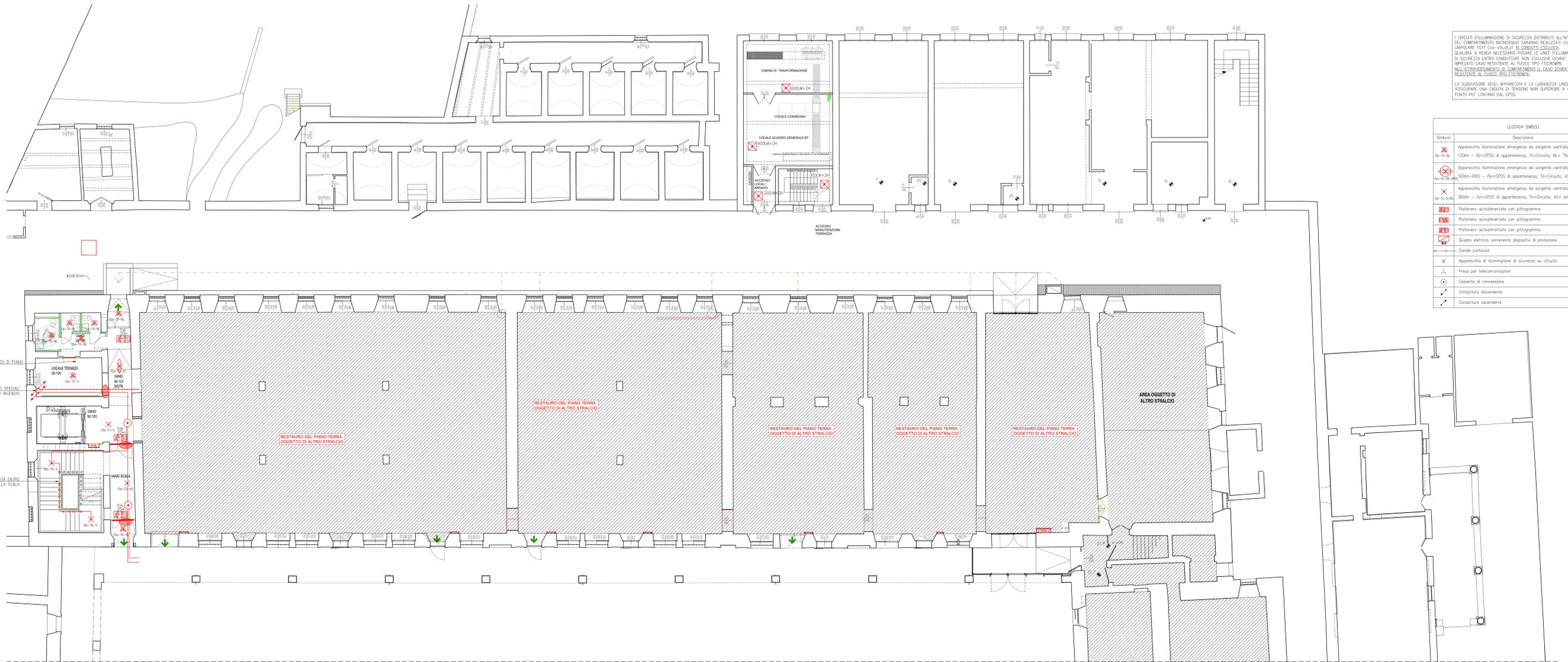
I CIRCUITI D'ILLUMINAZIONE DI SICUREZZA DISTINTI ALL'INTERNO DEI COMPARTIMENTI ANTINCENDIO SARANNO REALIZZATI CON CAVO UNIPOLARE FOT Coa-1h/2h AT IL COGNETTO ESCLUSO. QUALORA SI RENDIA NECESSARIO POSARE LE LINEE D'ILLUMINAZIONE DI SICUREZZA ENTRO CONDUTTURE NON ESCLUSIVE DOVRA' ESSERE IMPIEGATO CAVO RESISTENTE AL FUOCO TR0 F1000MM. NELL'ATTRAVERSO DI COMPARTIMENTI IL CAVO DOVRA' ESSERE RESISTENTE AL FUOCO TR0 F1000MM.
