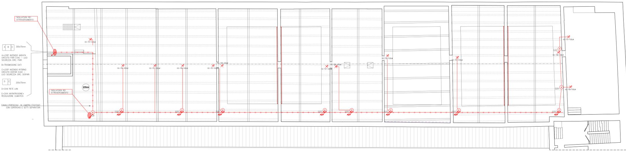
I CIRCUITI D'ILLUMINAZIONE DI SICUREZZA DISTRIBUITI ALL'INTERNO DEL COMPARTIMENTO ANTINCENDIO SARANNO REALIZZATI CON CAVO UNIPOLARE FOT (Ca+13u24) IN CONDOTTI ESCLUSIVI. QUALORA SI RENGA NECESSARIO POSARE LE LINEE D'ILLUMINAZIONE DI SICUREZZA ENTRO CONDOTTE NON ESCLUSIVE DOVRA' ESSERE IMPIEGATO CAVO RESISTENTE AL FUOCO TIPO FIBROM6. NELL'ATTRAVERSAmento DI COMPARTIMENTI IL CAVO DOVRA' ESSERE RESISTENTE AL FUOCO TIPO FIBROM6.
