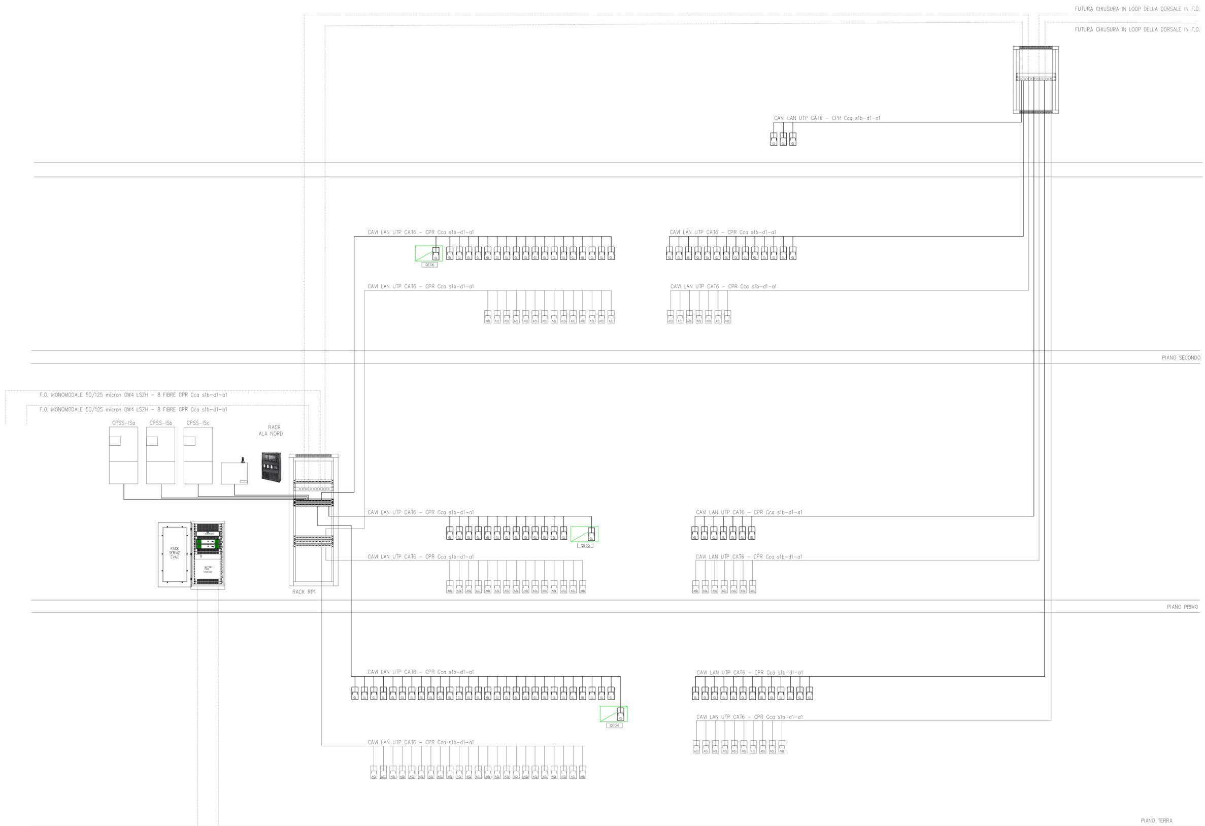
Nota: Tutti i cavi impiegati dovranno avere caratteristica LSZH CPR Cca - s1a -d1-a1
