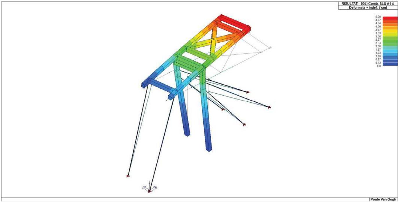
Figura 19 – Deformata massima (SLU)
