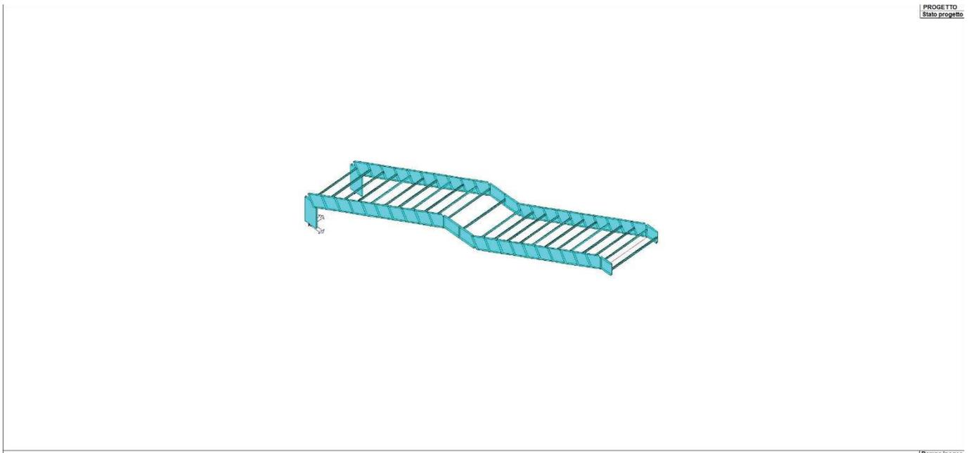
Figura 12 – Verifica delle strutture di acciaio (colore ciano = verifica positiva)
