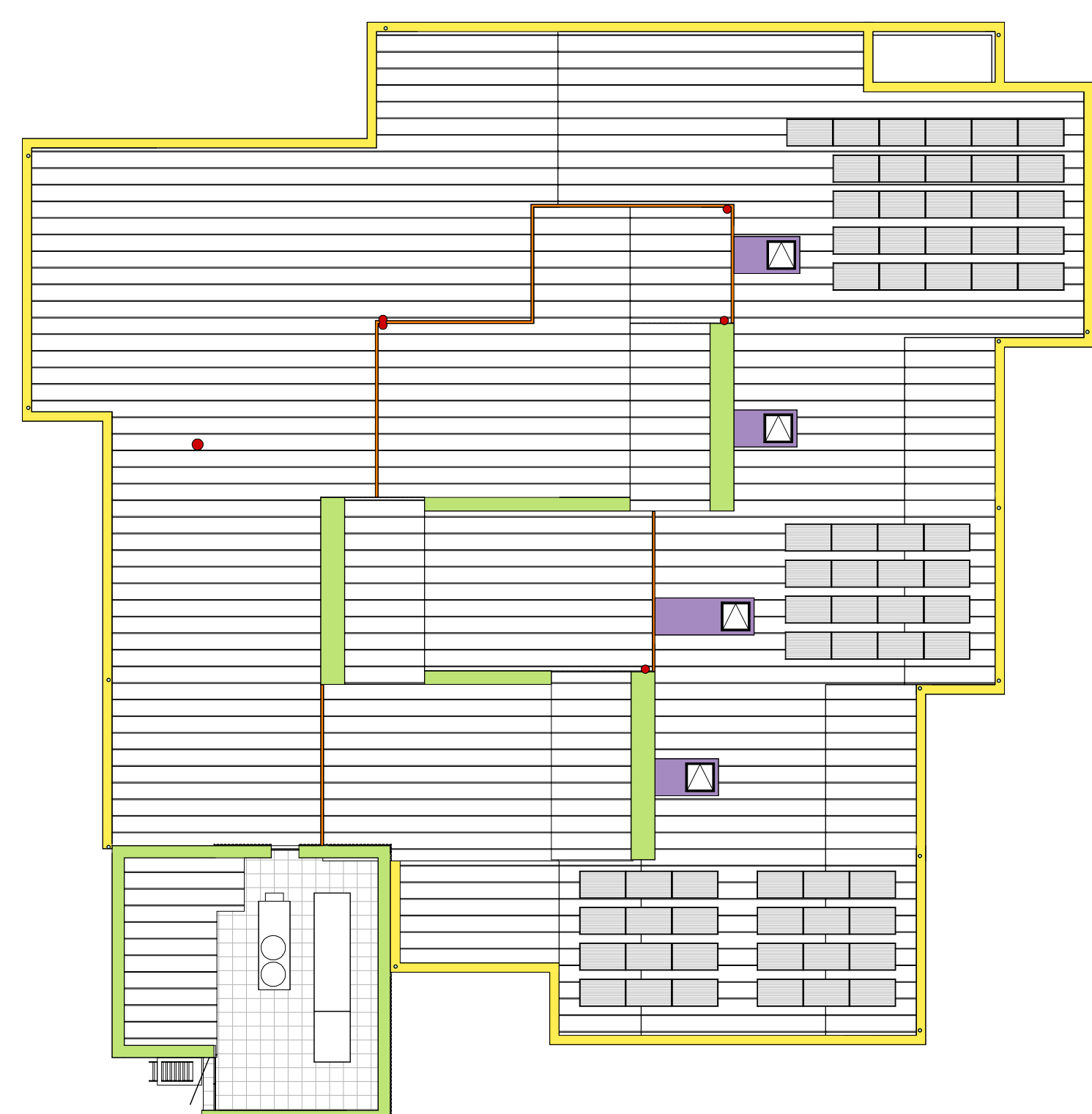
KEYMAP - INDIVIDUAZIONE ELEMENTI DI LATTONERIA E RACCOLTA ACQUE
