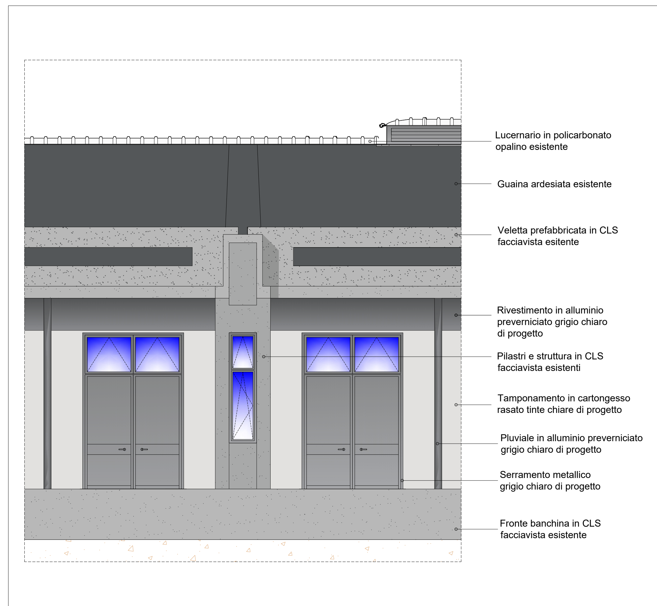
Particolare prospettico - scala 1:50
