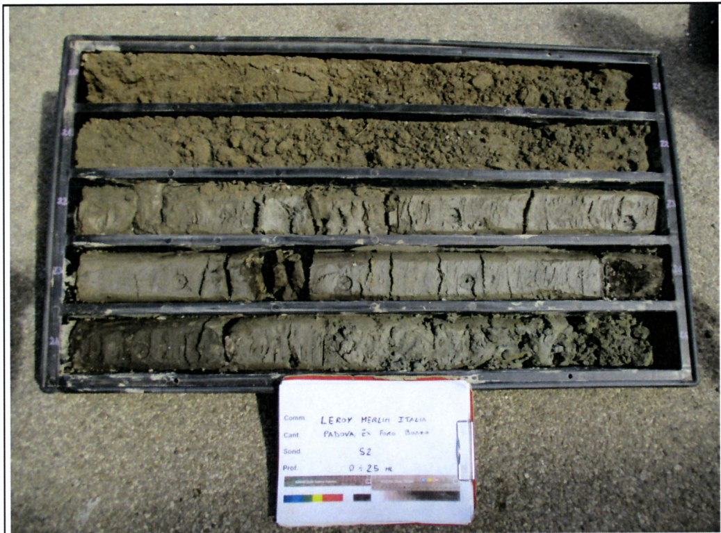
Sondaggio S2 – Cassetta N. 5 : da 20.0 m a 25.0 m
