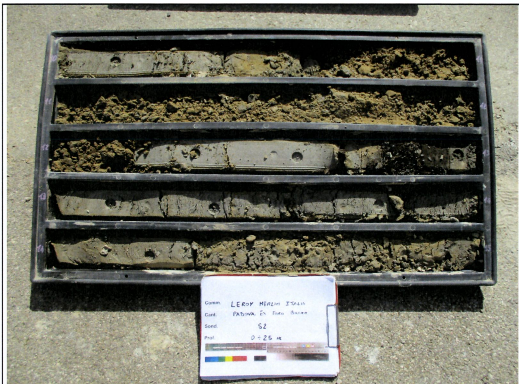
Sondaggio S2 – Cassetta N. 3 : da 10.0 m a 15.0 m
