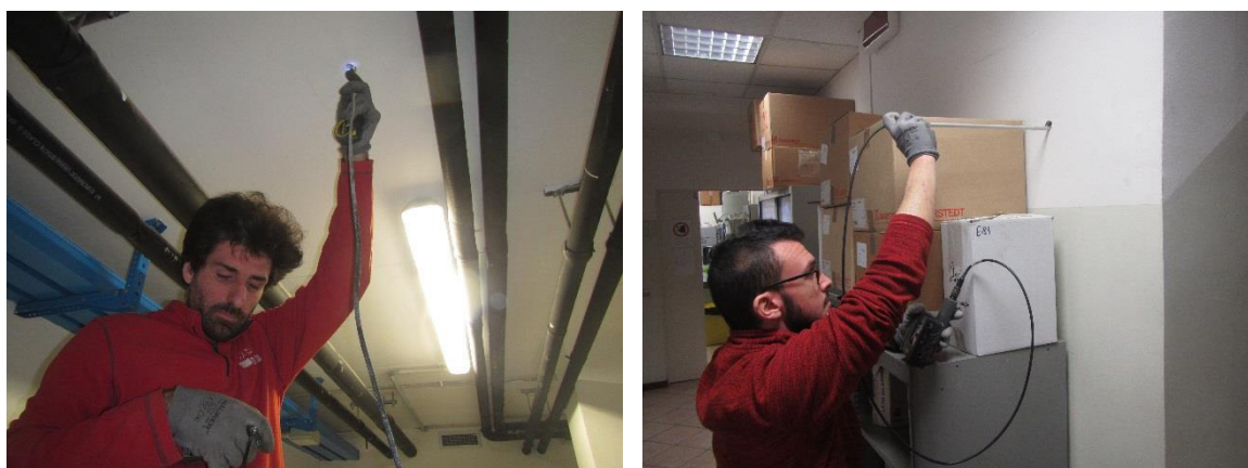
Figura 3.9: esecuzione delle indagini videoendoscopiche
