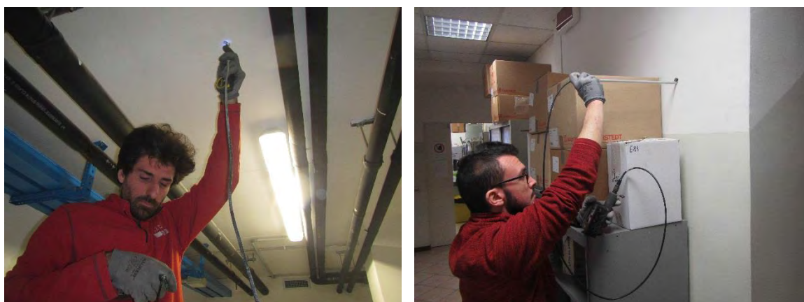
Figura 3.9: esecuzione delle indagini videoendoscopiche
