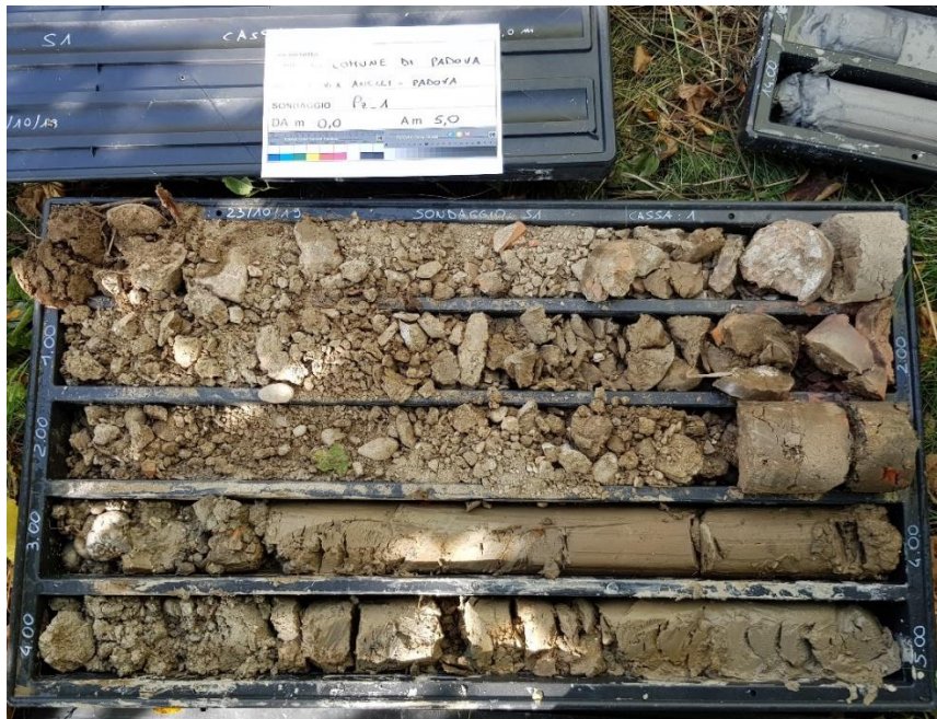
Figura 3 – Sondaggio Pz_1, profondità 0,00 -5,00m.
