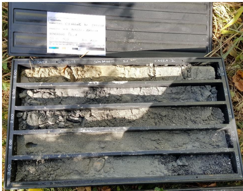
Figura 4 - Sondaggio Pz_1, profondità 5,00-10,00m.
