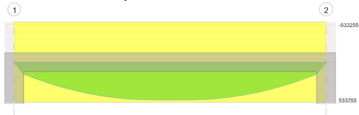
Diagramma verifica stato limite ultimo flessione
