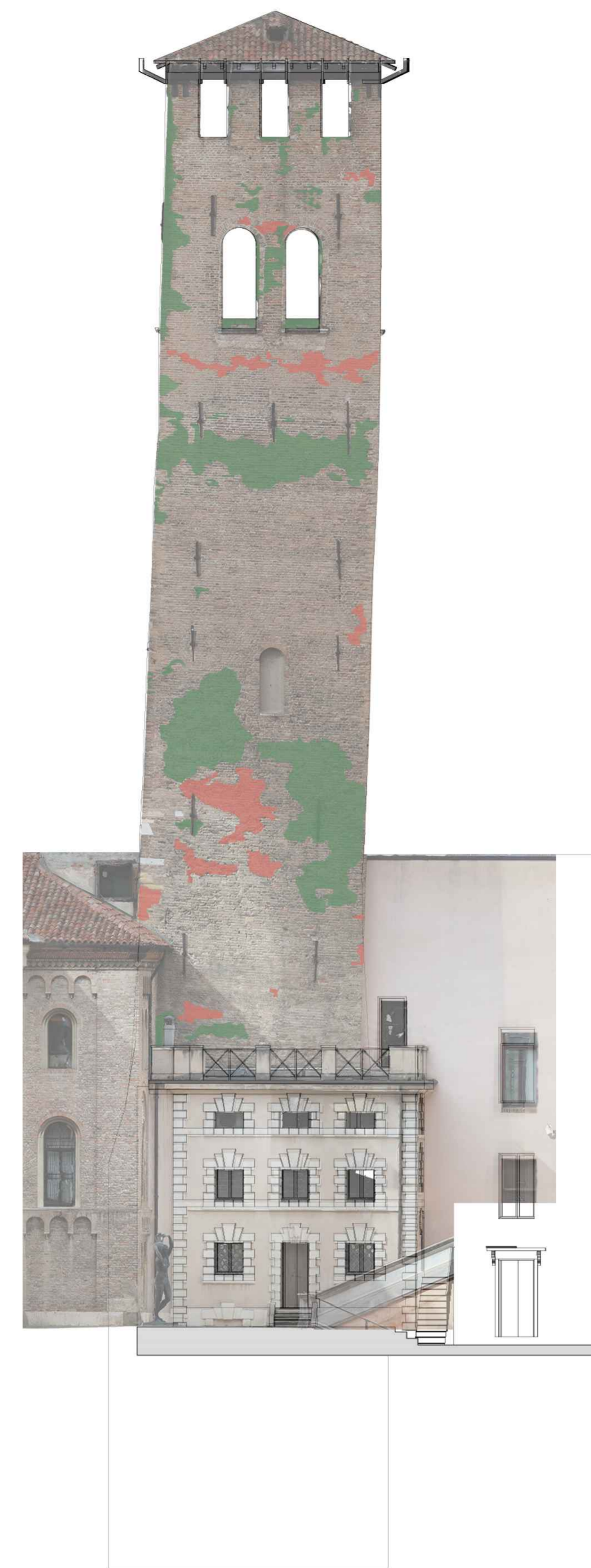
PROSPETTO SUD DEGRADO
