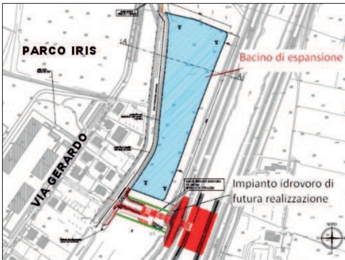
Fig. 13: bacino di espansione in fase di realizzazione da parte del Comune di Padova
