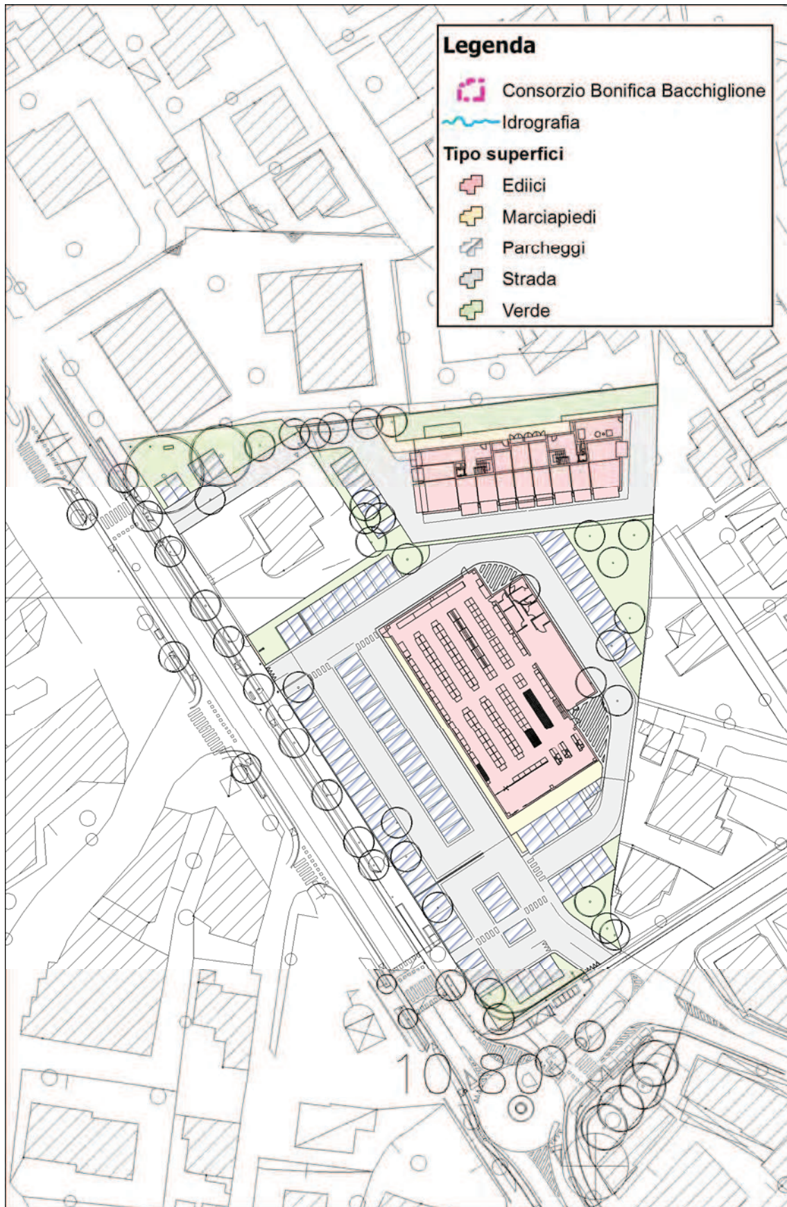
Figura 6 – Suddivisione dell'area dell'intervento in zone omogenee – scala 1:1'000
