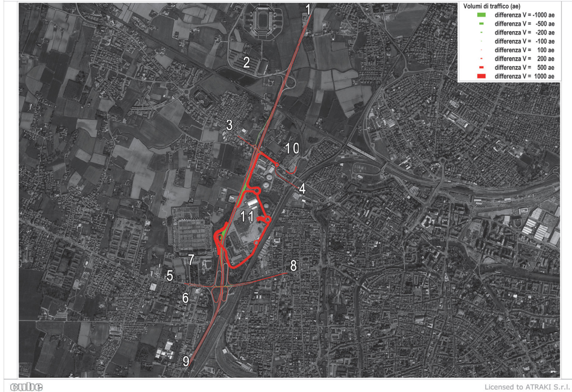
Figura 4.1 – Flussogrammi relativi agli scenari di riferimento e flussogramma differenza rispetto all'attuale. Veicoli totali. Fascia oraria 17:45-18:45 del venerdì.
