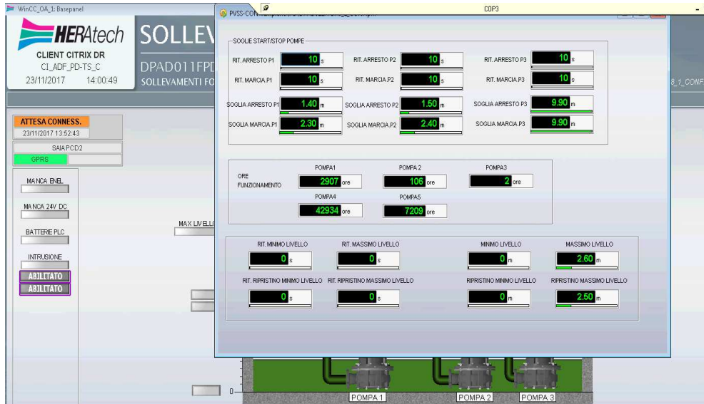
Figura 11.1 - Soglie di marcia e arresto dell'impianto idrovoro di Isola di Torre, fornite dall'ente gestore.
