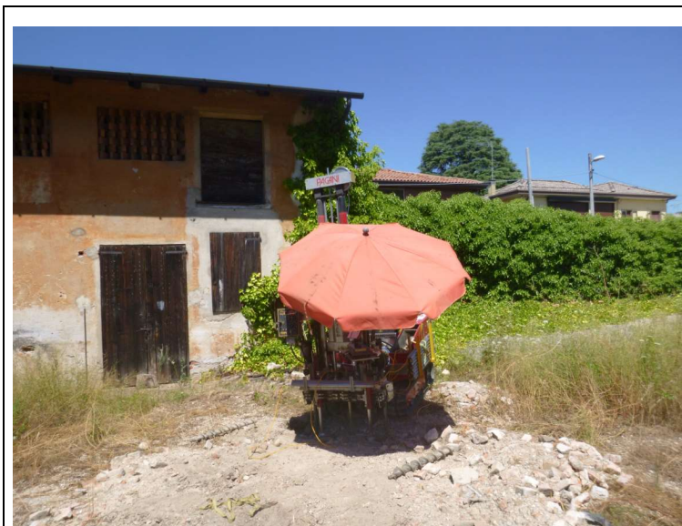
Foto 4: Esecuzione della prova CPTU4
