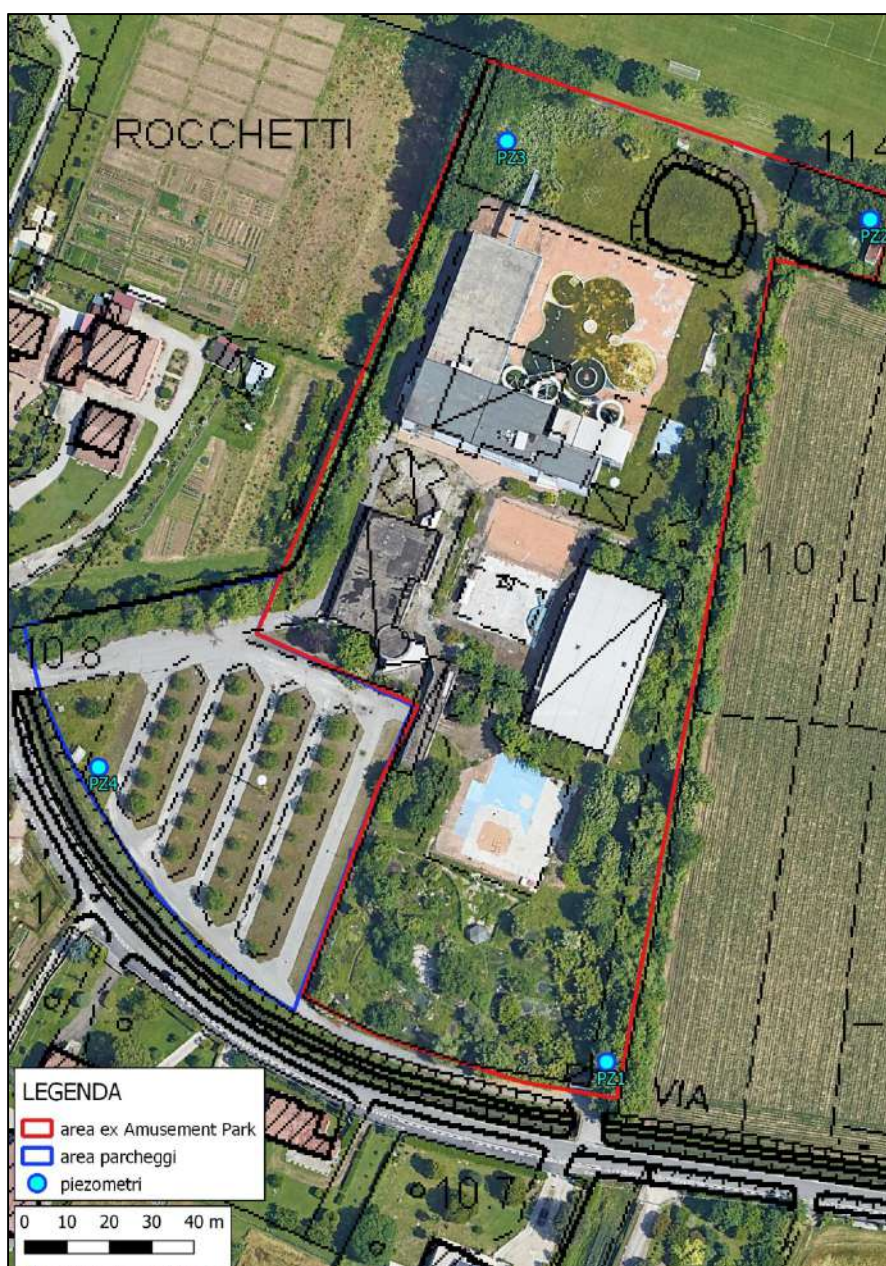
Figura 4.2 – Ubicazione dei piezometri installati
