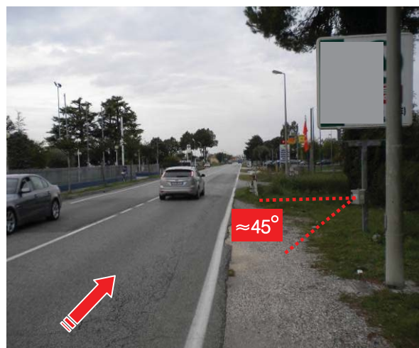
Figura 27 – Angolo di installazione dei radar rispetto alla direzione di marcia
