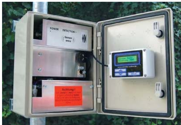
Figura 26 – Strumentazione radar Wavetech utilizzata
