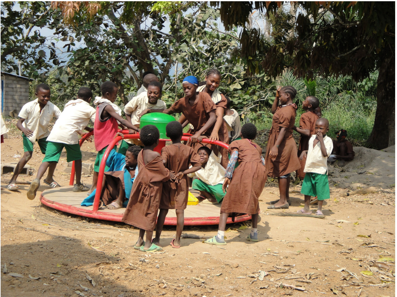
Pozzo a giostra realizzato da IFP nel 2009 nel sud del Camerun
