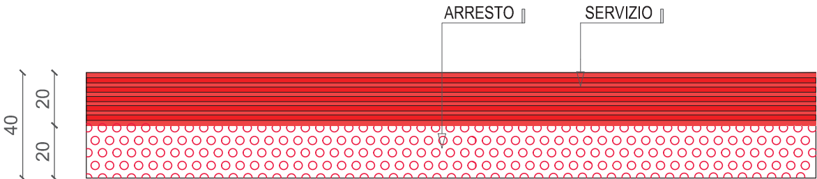
SEGNALE PEDOTATTILE Codice "Pericolo valicabile" Scala 1:20
