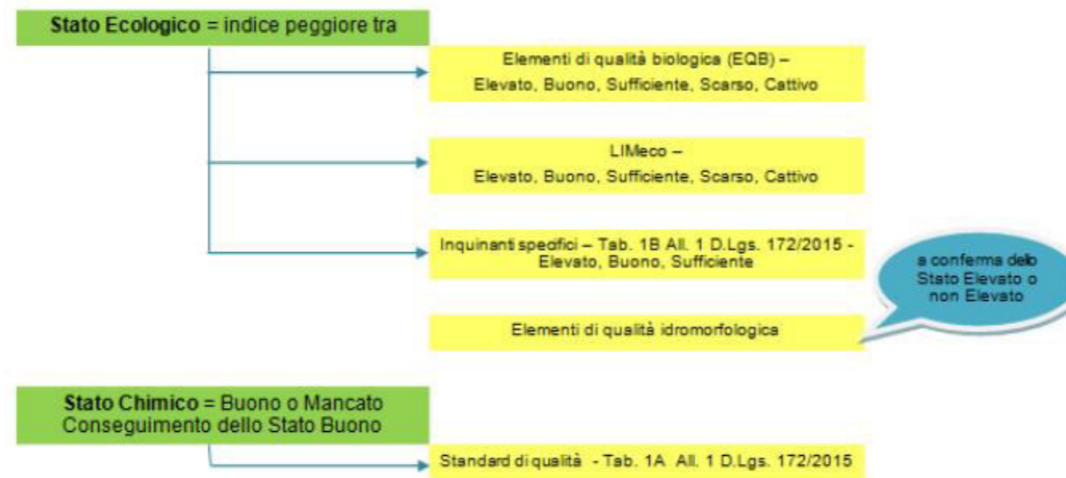
Figura 2-20: Schema di rappresentazione dello stato ecologico e chimico del Corpo Idrico superficiale; Fonte ARPAV.
