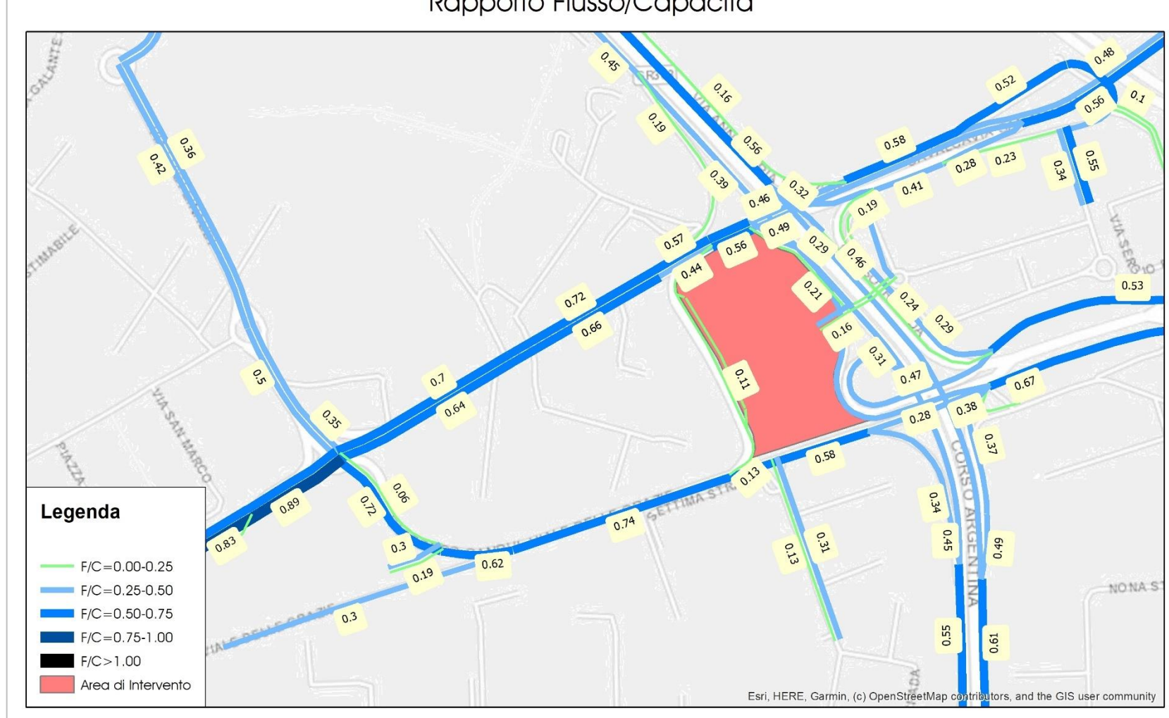
Figura 68 – Scenario di Intervento – Ipotesi 1 – Ora di Punta del Venerdì sera – Rapporto Flusso/Capacità
