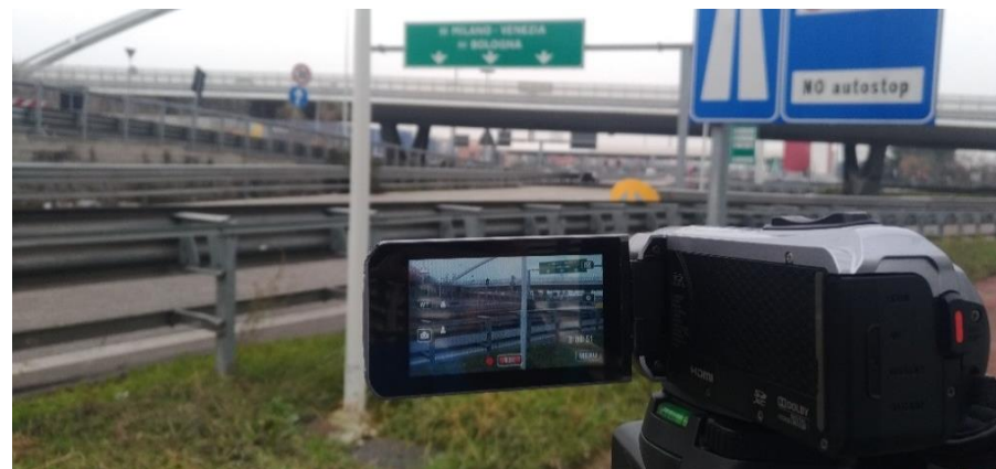
Foto 19 – Esempio di installazione per il rilievo di traffico con telecamere
