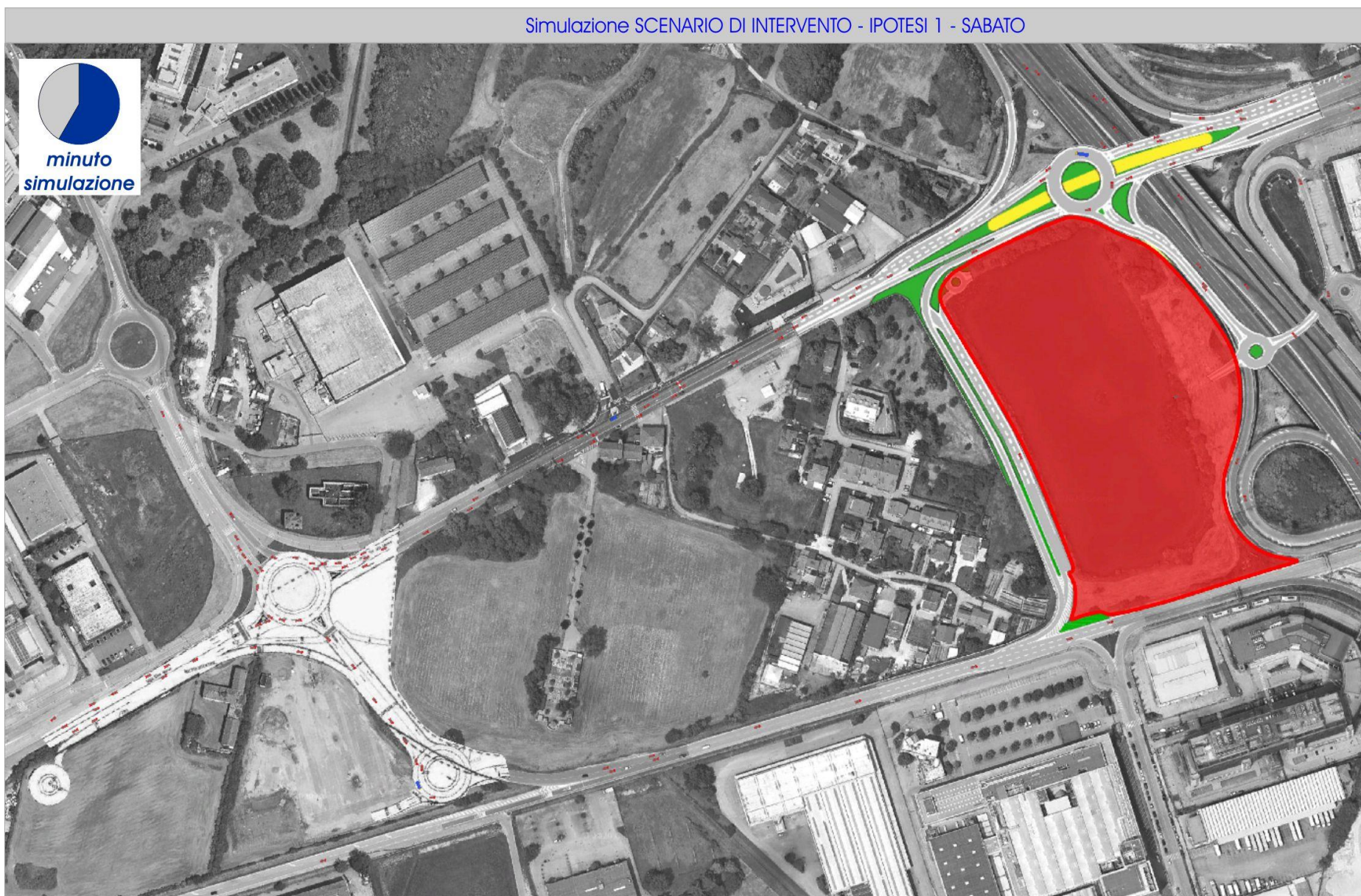
Figura 120 – Scenario di Intervento – Ipotesi 1 – Ora di Punta del Sabato Sera – Istantanea dopo 35 minuti di simulazione
