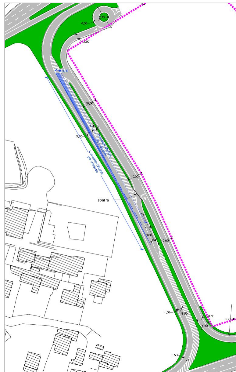
Figura 16 – Contro-strada lungo via Franceschini – Ipotesi 1 – Planimetria di progetto
