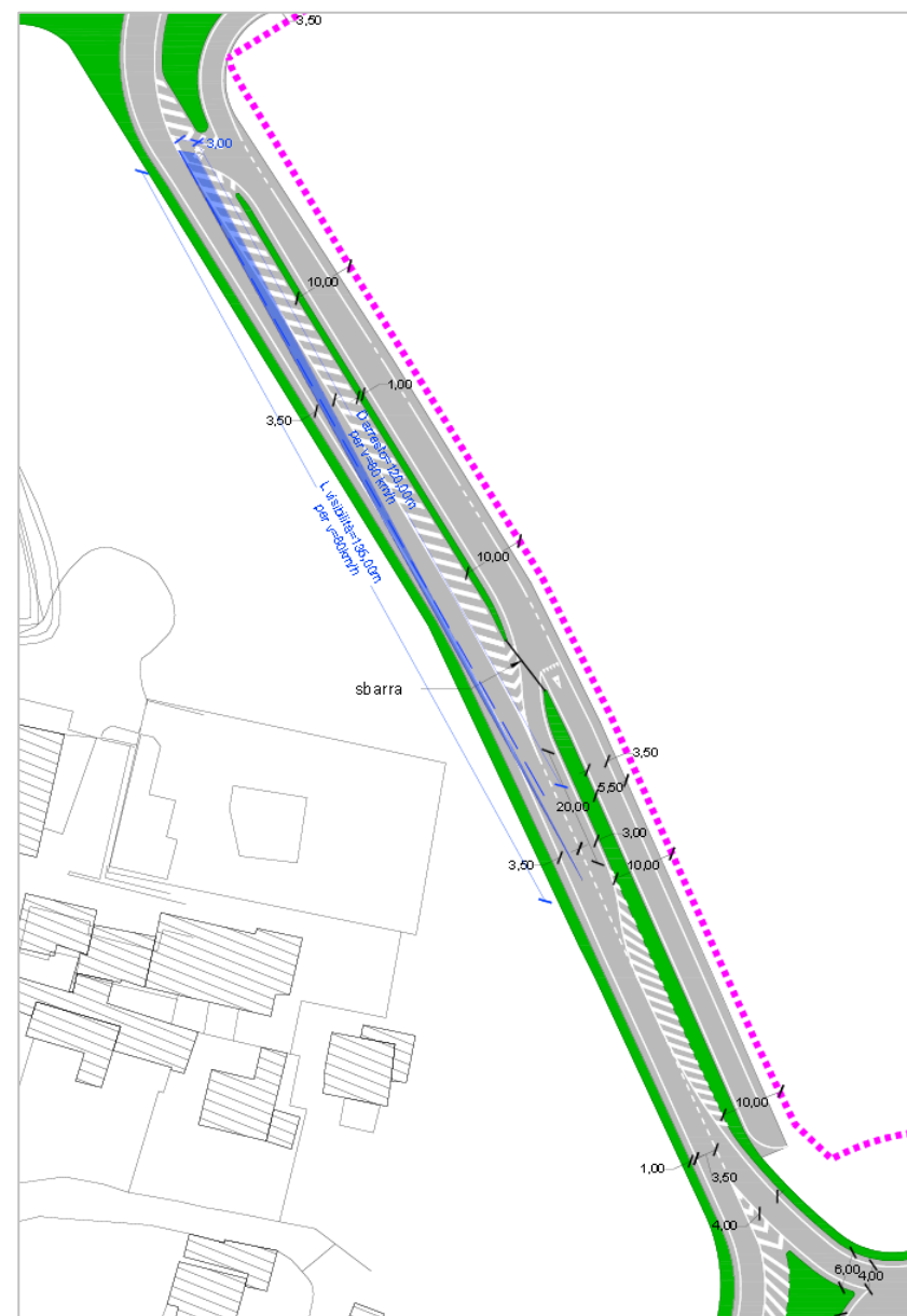
Figura 20 – Contro-strada lungo via Franceschini – Ipotesi 2 – Planimetria di progetto
