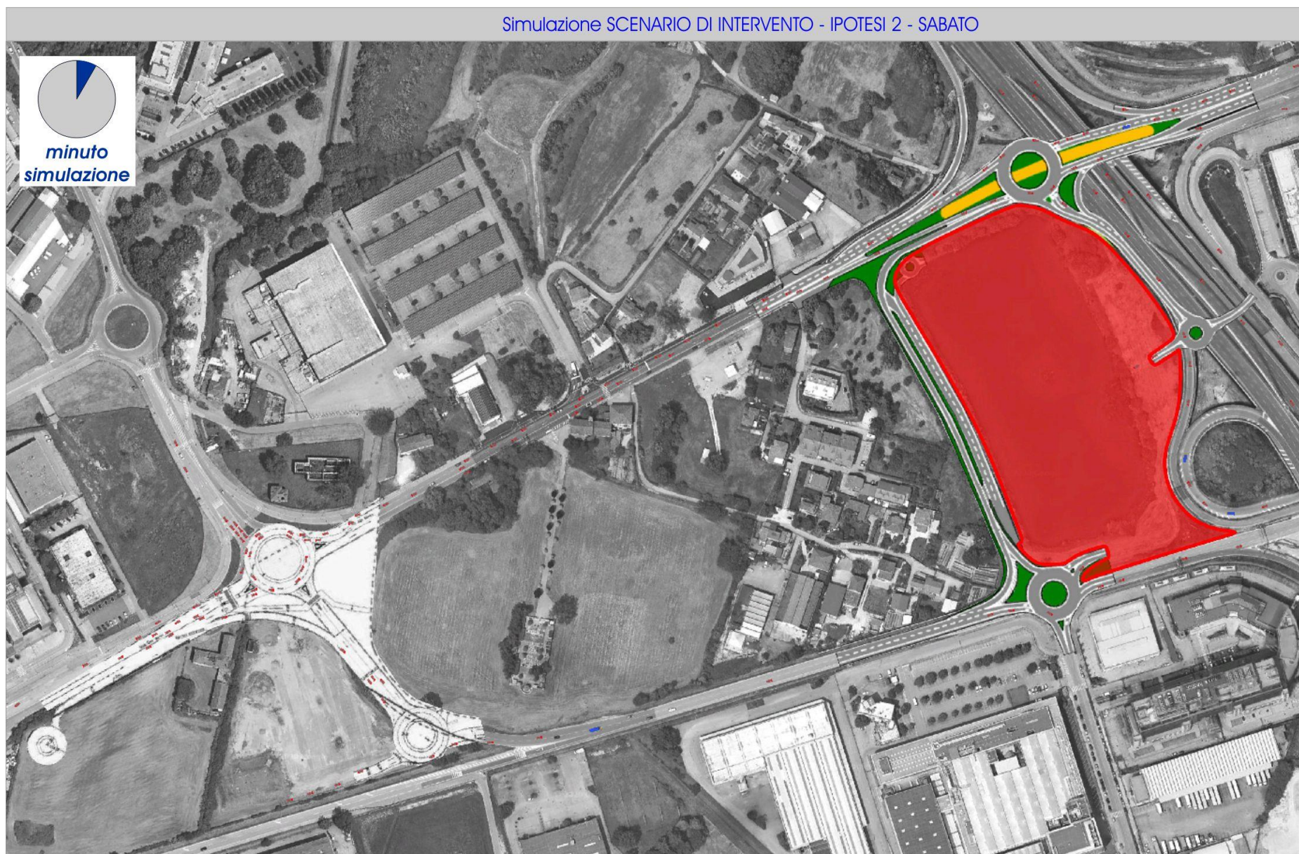
Figura 138 – Scenario di Intervento – Ipotesi 2 – Ora di Punta del Sabato Sera –Istantanea dopo 5 minuti di simulazione
