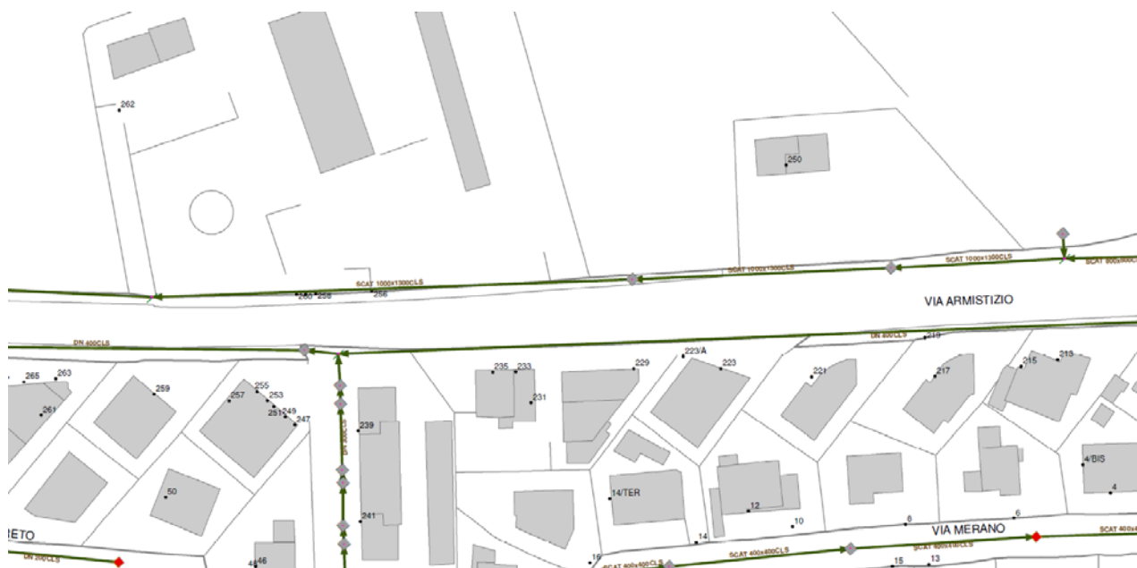
Figura 10: possibile recapito in rete di fognatura (mista) esistente in via Armistizio, da utilizzare per la rete acque nere
