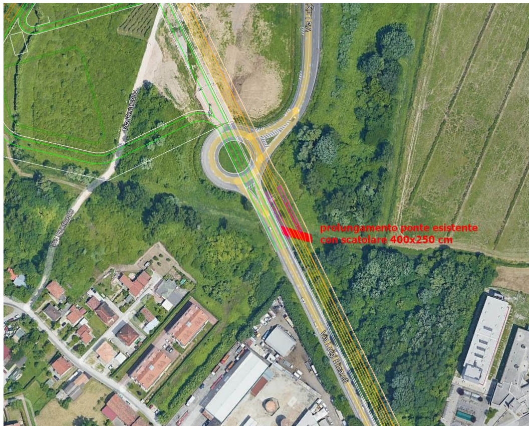
Figura 8-10: Prolungamento ponte sullo scolo Mestrina.
